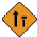
Prawy pas (z dwóch) zamknięty
